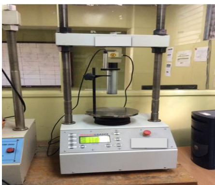
Fig. 4 Máquina de carga para compresión
