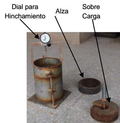
Fig. 3 Instrumento del CBR
